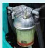
Kraftstoffvorfilter mit eingebautem Wasserabscheider
