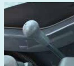
Der Planierschild-Hebel verfügt für einen präzisen Betrieb über eine Hydraulik-Vorsteuerung.
