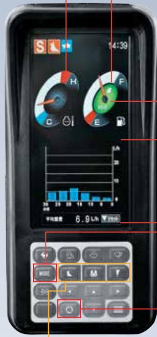
Analoges Messgerät für intuitives Ablesen des Kraftstoffstands und der Kühlwassertemperatur
