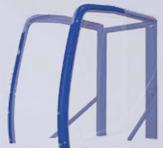
• Überrollschutz der Klasse 2 (FOPS-Schutzaufbau) (ISO 10262) serienmäßig.
