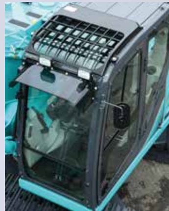
• Überrollschutz der Klasse 2 (FOPS-Schutzaufbau) (ISO 10262) serienmäßig.
