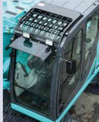
• Überrollschutz der Klasse 2 (FOPS-Schutzaufbau) (ISO 10262) serienmäßig.
