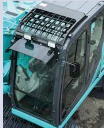
• Schutzaufbau Klasse 2 (FOPS) (ISO 10262) serienmäßig.
