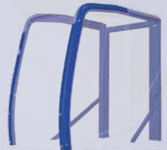
• Schutzaufbau Klasse 2 (FOPS) (ISO 10262) serienmäßig.
