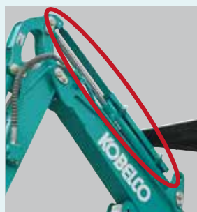
Schutz des Stielzylinderkolbens
