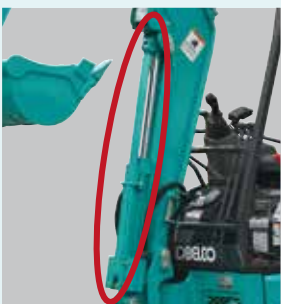
Schutz des Auslegerzylinderkolbens
