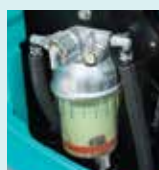
Kraftstoffvorfilter mit eingebautem Wasserabscheider
