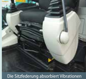
Die Sitzfederung absorbiert Vibrationen
