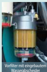
Kraftstofffilter mit eingebautem Wasserabscheider
