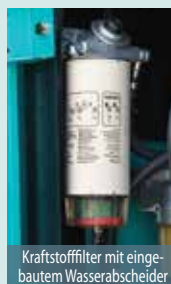
Vorfilter mit eingebautem Wasserabscheider
