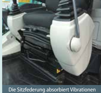
Die Sitzfederung absorbiert Vibrationen
