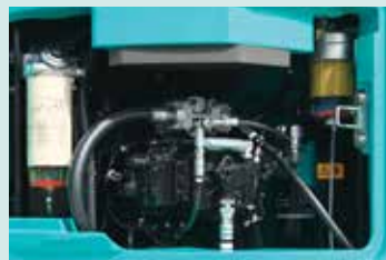
Kraftstofffilter mit eingebautem Wasserabscheider
