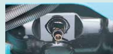
Kraftstofffilter mit eingebautem Wasserabscheider
