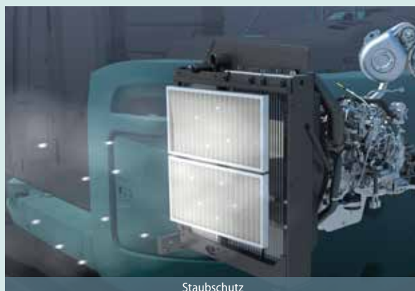
So hält der Filter Staub zurück
