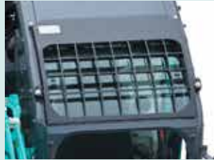
Dach-Schutzgitter Stufe II (erfüllt ISO10262)
