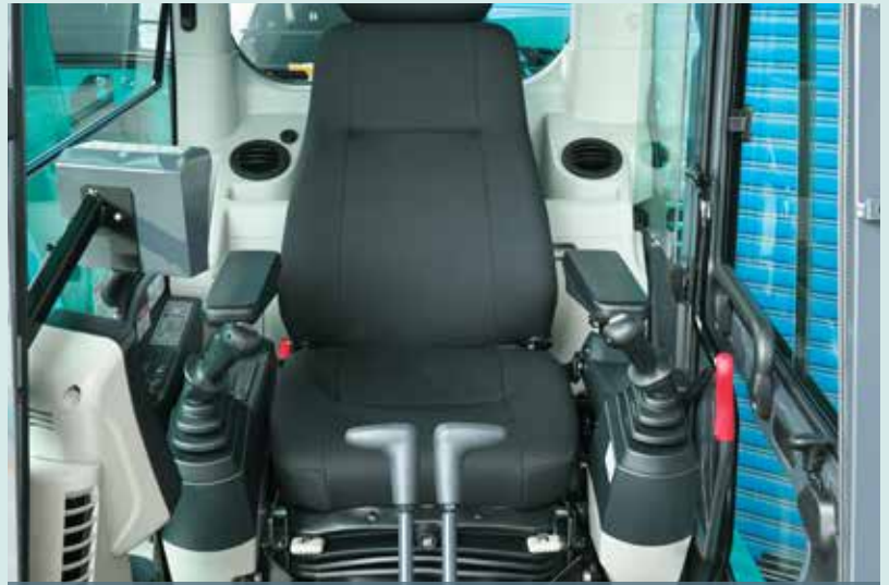
Die Sitzfederung absorbiert Vibrationen
